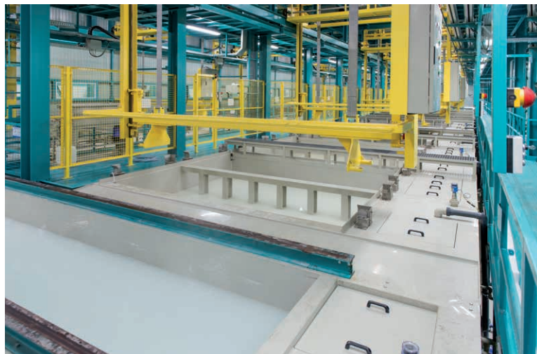
Die Oberflächenspezialisten von BENSELER haben für die Vorbehandlung der vor Korrosion zu schützenden Leichtmetalle eine spezielle Abfolge von 14 Aktiv- und 16 Spülbädern erarbeitet, die sich für eine Vielzahl unterschiedlicher Substrate und Legierungen eignet.
